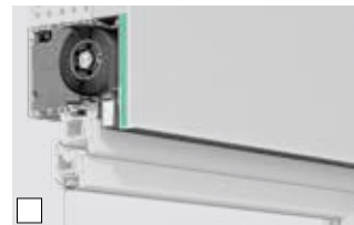
RA zipSCREEN met hoekprofiel buiten 35 mm dieper gezet, voor onzichtbare onderlijst
